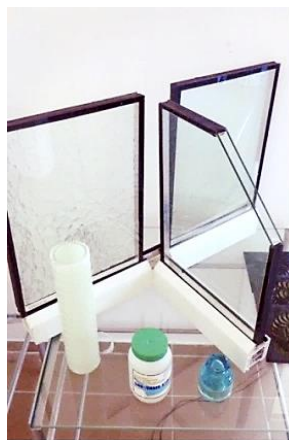
1.12 pav. Stiklo paketų maketas. Prie aliuminio arba polivinilchlorido skečiamojo rėmelio priklijuoti du lakštinio stiklo švieslakščiai. L = 400\text{--}2950 mm, B = 400\text{--}2650 mm, storis ne didesnis kaip 46 mm. AB „Panevėžio stiklas“, 1997 m.
